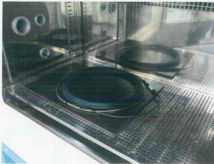
그림 8. 온도 변화 시험 : 정속 온도 변화
